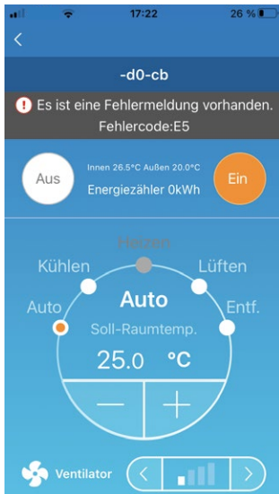
Abbildung 70: Fehlercode auf der Seite Übersicht Innengeräte
