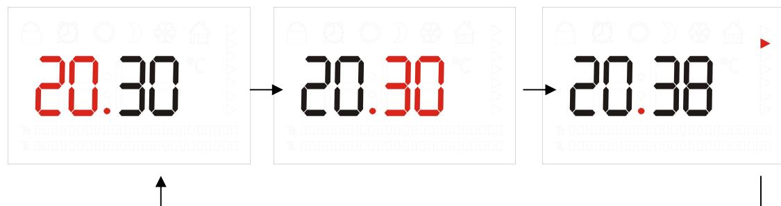
Pro změnu použijte tlačítko nebo . Po 5 sekundách nečinnosti si zařízení nový čas zapamatuje a program se vrátí zpět do funkce HODINY.
