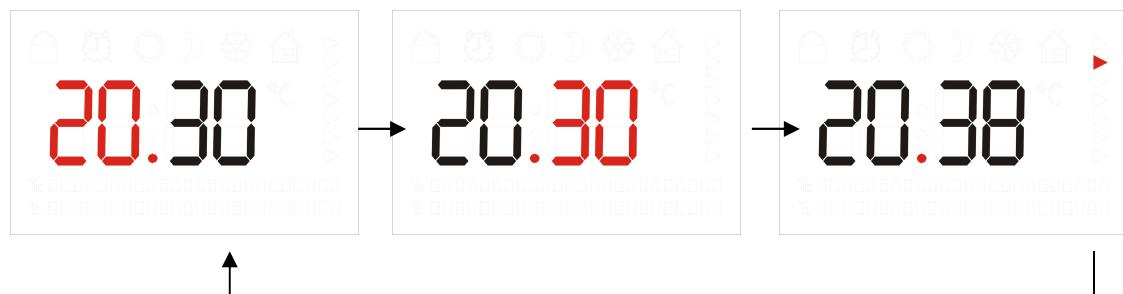
A változtatáshoz használja a vagy nyomógombokat. 5 másodperc télenség után a berendezés megjegyzi az új időt, és a program visszatér az ÓRA funkcióba.
