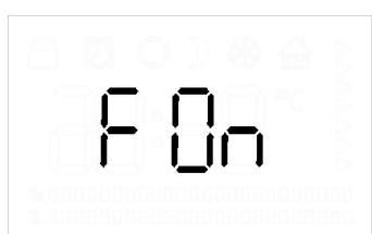
F On: Detekce otevření okna aktivována
