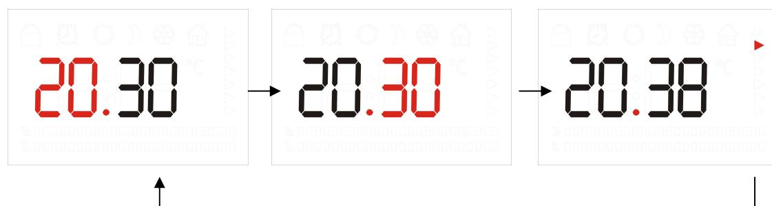
Na zmenu použite tlačidlo alebo . Po 5 sekundách nečinnosti si zariadenie nový čas zapamätá a program sa vráti späť do funkcie HODINY.
