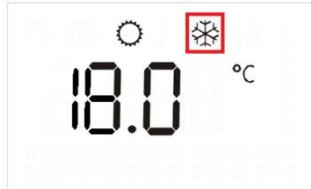
Il simbolo del fiocco di neve deve lampeggiare se viene rilevata apertura di una finestra.
