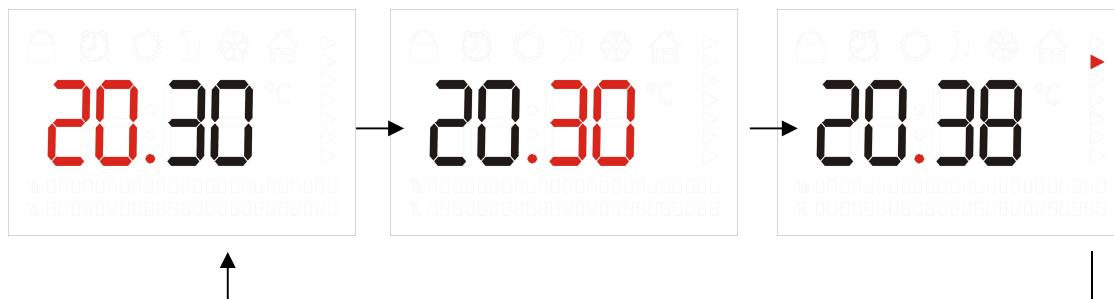
Zur Änderung ist die Taste oder zu verwenden. Wenn über einen Zeitraum von 5 Sekunden keine Aktivität erfolgt, speichert das Gerät die neue Uhrzeit und das Programm kehrt zur UHRFUNKTION zurück.
