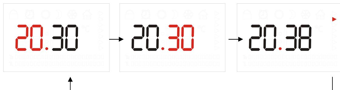
For endring, bruk tasten eller . Etter 5 sekunder når det ikke trykkes på noe, husker enheten det nye klokkeslettet, og programmet kommer tilbake i KLOKKE-funksjon.
