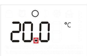
Quando la funzione rilevamento della finestra aperta è attiva (F On) e la temperatura è stabile, lampeggia il punto decimale (cfr. allegato "TEMPERATURA STABILE")
